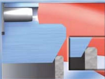
1. „Efecto Autolimpiante“ - la forma cónica del asiento marginal elimina las deposiciones de la superficie durante el cierre
