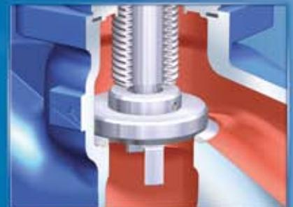
3. Guía del eje adicional mediante el obturador guiado (permite mayor presión diferencial)
